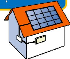
太陽光発電の主なシステムは、「太陽光パネル」「パワーコンディショナー(パワコン)」「接続箱」です。「太陽光パネル」は比較的故障が少なく、長期的に使えますが、故障が多くなるのは「パワコン」です。
